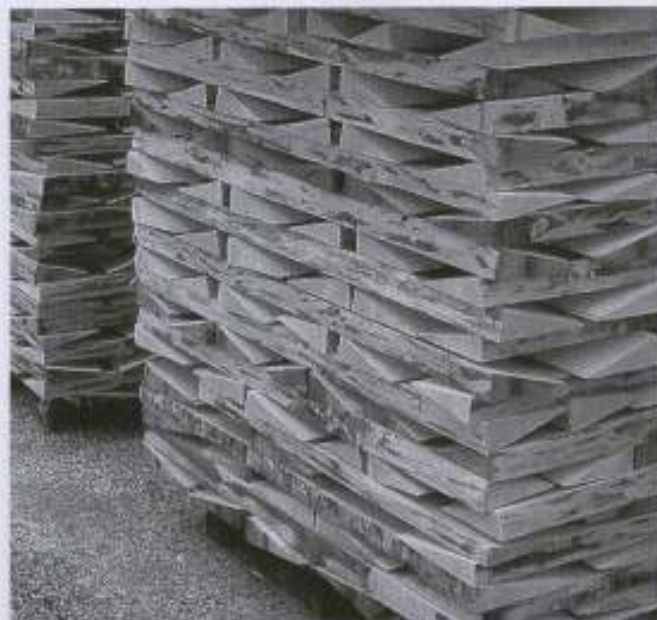
Tagli selezionati di abete rosso, messi a stagionare per 3 o 4 anni. Alla fine, soltanto i migliori diventeranno musica.
